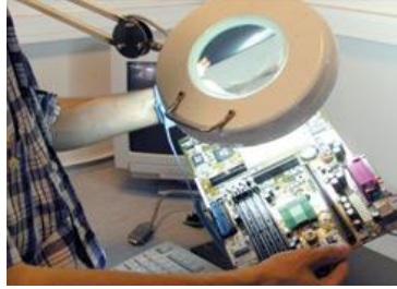
Resim 1. 6: PCB kontrolü yapmak için kullanılan ışıklı büyüteç
