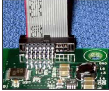
Resim 2. 27: SpO 2 modül bağlantı konnektörü
